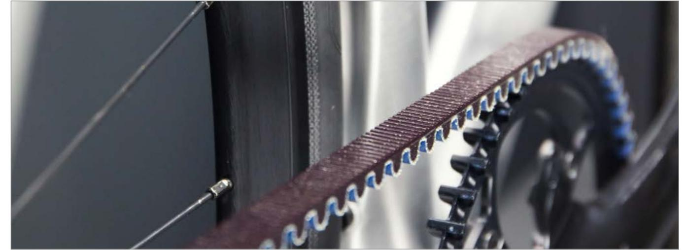
ist allerdings die Wartungsarmut. Das übliche Fetten und Ölen der Kette und damit auch das lästige „Hosenbein-hochkrepeln“ sind passé. Zum Spannen des Riemens haben wir das Crocodile-Spannsystem entwickelt und patentiert. Und weil uns neben optimaler Funktionalität ebensoviel an der Ästhetik gelegen ist, verfügen unsere Rahmen über die ebenfalls patentierte Schindelhauer Belt Port Technologie, die trotz
